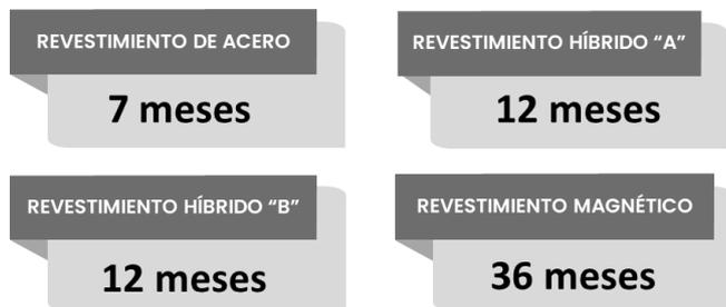
**Figura 8** Duración por tipo de revestimiento
