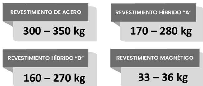
**Figura 7** Peso por pieza por tipo de revestimiento
