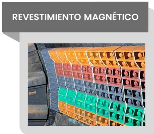
**Figura 6** Revestimiento magnético
